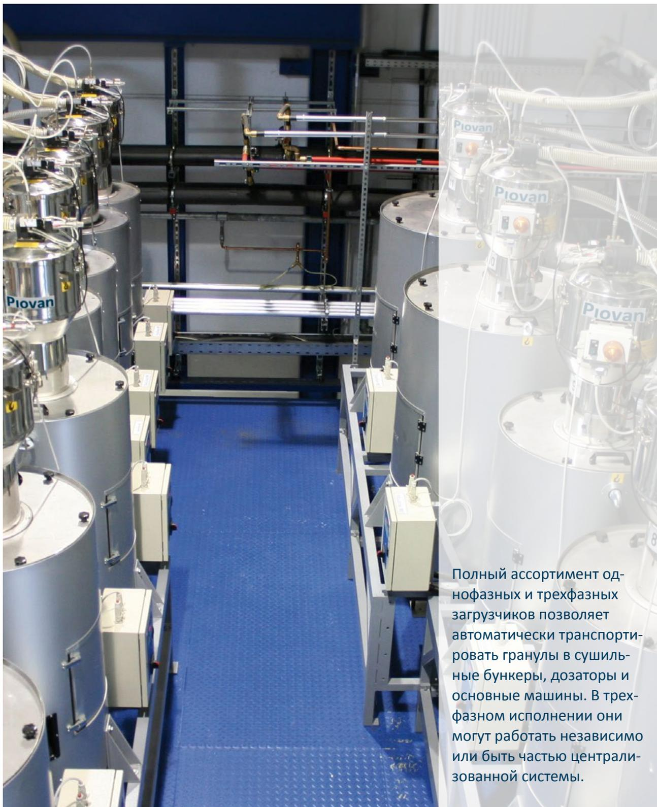
Полный ассортимент однофазных и трехфазных загрузчиков позволяет автоматически транспортировать гранулы в сушильные бункеры, дозаторы и основные машины. В трехфазном исполнении они могут работать независимо или быть частью централизованной системы.
