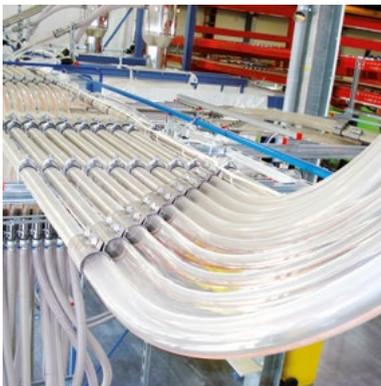
(1) трубопровод со стеклянными поворотами
