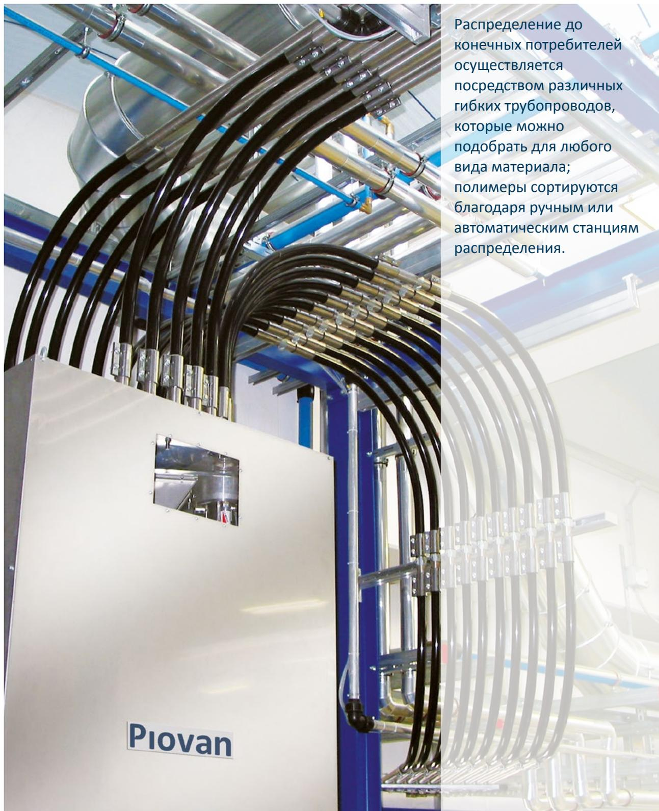
Распределение до конечных потребителей осуществляется посредством различных гибких трубопроводов, которые можно подобрать для любого вида материала; полимеры сортируются благодаря ручным или автоматическим станциям распределения.
