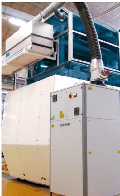
Генератор нагнетает поток сухого воздуха внутрь зоны пресс-формы, чтобы избежать образования конденсата на поверхности и в гнездах пресс-формы в случае изменения условий окружающей среды.
